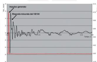
Esempio di risultato con vibrometro
