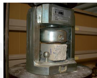
Prova di compressione su provini di malta
