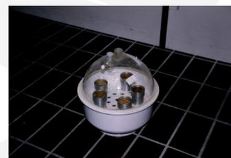
Prova di permeabilità al vapore
