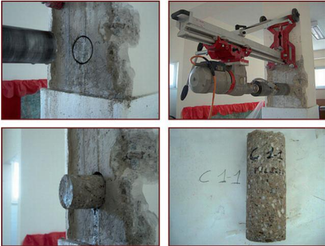
UNI, deve essere almeno pari a tre volte il diametro massimo dell'inerte presente nel calcestruzzo. Quando il campione ha un rapporto altezza/diametro pari a due, è possibile passare dalla resistenza cilindrica ( $f_c$ ) che scaturisce dalla prova di compressione alla resistenza cubica ( $R_c$ ) utilizzando la seguente relazione riportata in molte normative:
