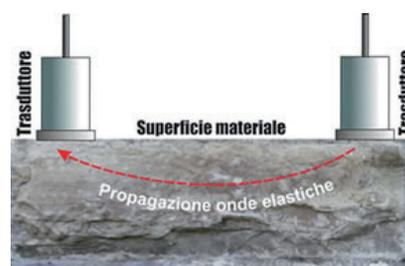
Determinazione, mediante trasmissione diretta, della presenza di difetti strutturali.
