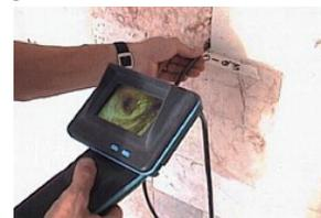
A seconda del tipo di apparecchiatura può cambiare la profondità massima di ispezione, il diametro minimo del foro d'ispezione (a seconda dello spessore della sonda) ed il diametro massimo (fori più grandi richiedono fonti di illuminazione più potenti per dare immagini con buona risoluzione e visibilità). Anche il campo di visione della sonda, rispetto alla visione diretta in avanti, può essere variabile.
