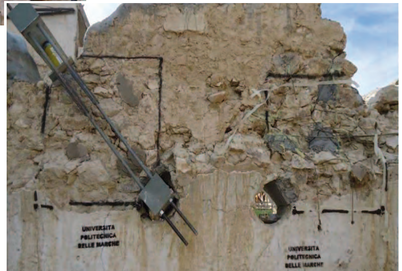
Figura 19: i pannelli di muratura in pietra (rinforzati e non) sottoposti a prova di compressione diagonale.
