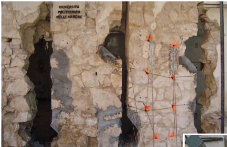
Figura 19: i pannelli di muratura in pietra (rinforzati e non) sottoposti a prova di compressione diagonale.
